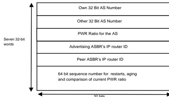
Fig. 9. AS-PATH-POWER-METRIC PDU
